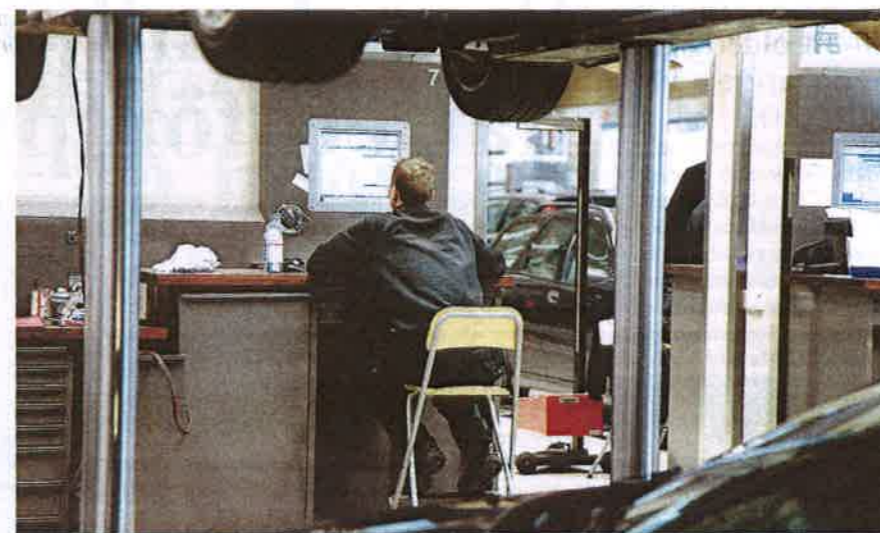
Varje mekaniker har sin egen arbetsplats. Dator för planering och andra ändamål ingår, liksom källsortering på stället. Verktygen ligger inte framme. De förvaras i särskilda utdragbara lådor.
